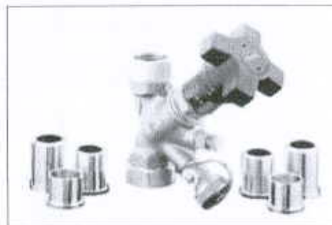
Zawór z gwintem zewnętrznym i nakrętką złączną do końcówek: ... stalowych do spawania dla rur od DN 10 do DN 50 ... do lutowania dla rur od 15 mm do 42 mm ... z gwintem zewnętrznym dla rur od DN 10 do DN 40
